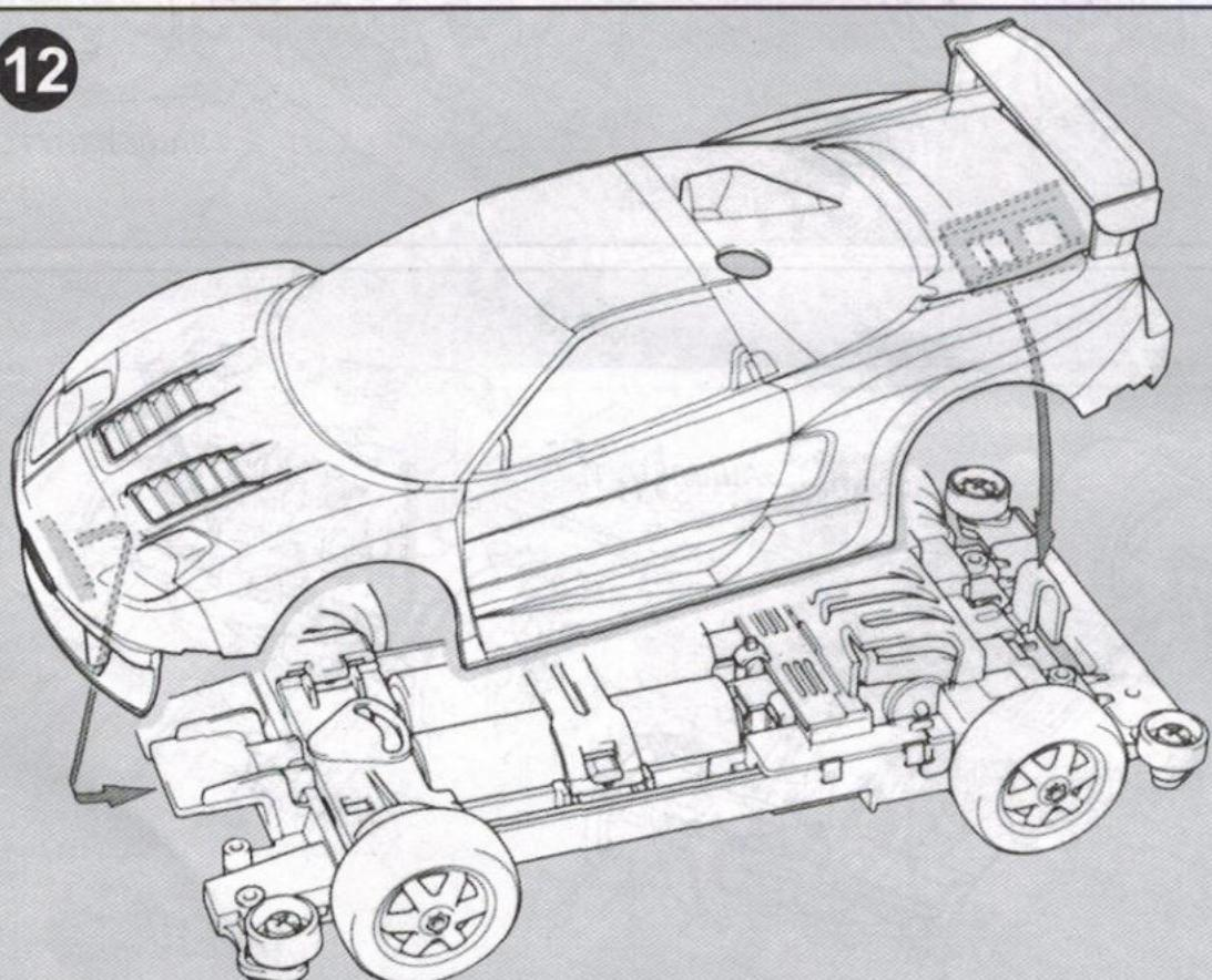
Как снять корпус.
